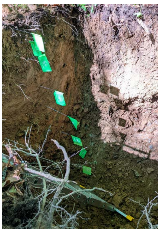
◀ Půdní čidla od Meter Environment, která měří vodní potenciál (pocitové sucho, vlevo) a vlhkost (vpravo) v půdě.
