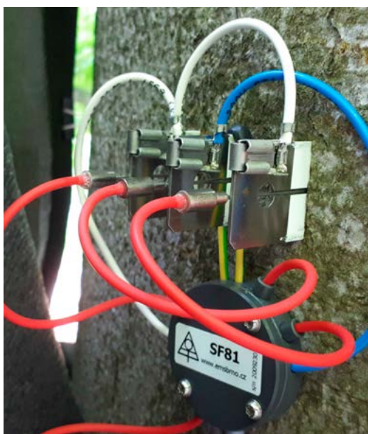
Průtokoměr (od EMS Brno) na kmeni buku lesního.
