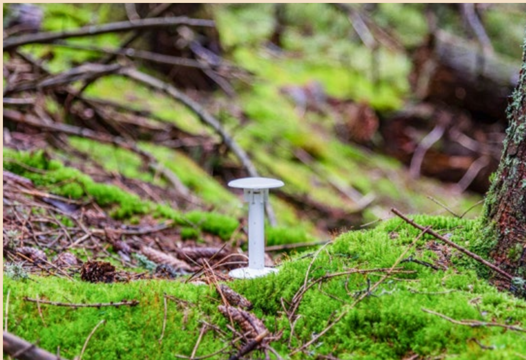
Mikroklimatické čidlo TMS4 měří teplotu vzduchu a teplotu a vlhkost půdy, instalované v horské smrčině.
